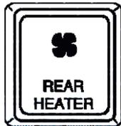
Нагретый воздух поступает через нижние вентиляционные отверстия расположенные под вторым рядом сидений.
