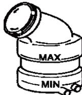
Уровень жидкости в контейнере не должен находиться на отметке ОПАСНОСТЬ, выше отметки МАКС или ниже отметки МИН.
