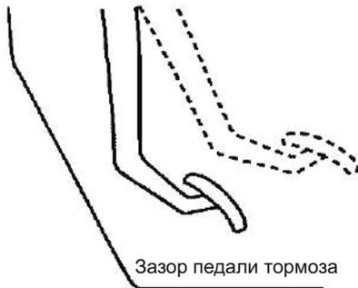
Зазор измеряется между центром верхней поверхности накладки педали тормоза и полом без коврика.
