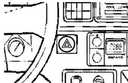
Аварийную световую сигнализацию можно включать как при включенном, так и при выключенном зажигании.
