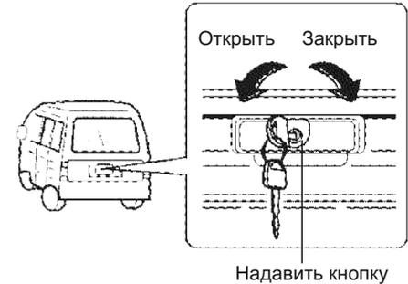
Чтобы открыть заднюю дверь поднимите ее нажав на кнопку замка. Если крышка багажника закрыта на замок, кнопка не может быть нажата.
