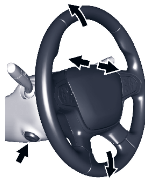
Регулировка рулевого колеса по вылету и углу наклона (электрическая)
