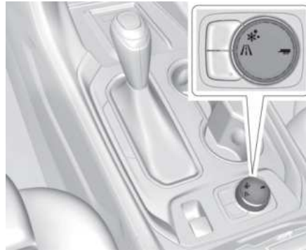
Рукоятка переключателя режимов движения (переднеприводный автомобиль)
