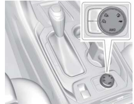
Рукоятка переключателя режимов движения (полноприводный автомобиль)
