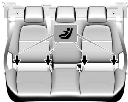
Ваш автомобиль оснащен крепежными скобами системы ISOFIX для установки детских удерживающих устройств.
