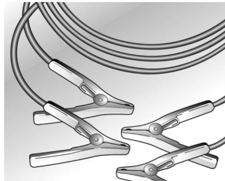
Если аккумуляторная батарея (АКБ) разрядилась, двигатель можно запустить с помощью вспомогательных пусковых проводов и батареи другого автомобиля. Это необходимо делать с максимальной осторожностью, соблюдая приведенные ниже указания.
