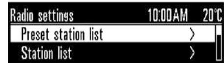
В диапазоне AM или FM нажмите SET (НАСТРОЙКА) в блоке органов управления на консоли, чтобы войти в «Setting menu» («Меню настройки») радиоприемника, и нажмите SET (НАСТРОЙКА) еще раз, чтобы войти в меню «Radio settings» («Настройки радиоприемника»).
