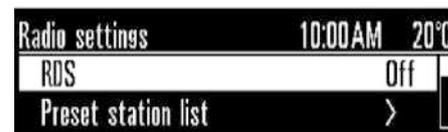
В диапазоне FM нажмите SET (НАСТРОЙКА) в блоке органов управления на консоли, чтобы войти в «Setting menu» («Меню настройки») радиоприемника, и нажмите SET (НАСТРОЙКА) еще раз, чтобы войти в меню «Radio settings» («Настройки радиоприемника»). Поверните ручку  $\curvearrowright$  для выбора «RDS», нажмите SET (НАСТРОЙКА), чтобы включить RDS, если функция выключена. Включение RDS и прием сигнала RDS отображается в середине главного экрана, а диапазон частот – в нижнем левом углу.
