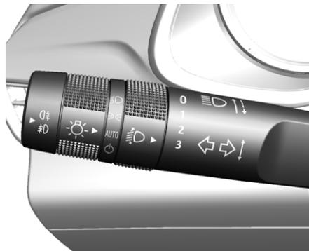
☹☹☹☹ : Чтобы включить дальний свет, при включенных фарах нажмите на рычаг указателя поворота от себя и отпустите. Чтобы вновь включить ближний свет,
