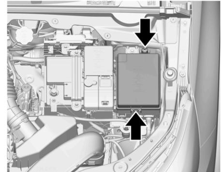
Блок предохранителей установлен в левой передней части моторного отсека.
