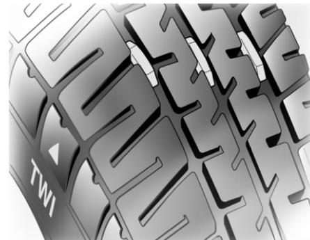
Установленной правилами минимальной глубине рисунка протектора (1,6 мм) соответствует появление индикаторов износа (TWI). Места индикаторов отмечены на боковине покрышки.
