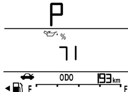
Отображается расчетный остаточный ресурс масла. Оставшийся ресурс масла указывается в процентах. Для сброса обратитесь к пункту «Сброс системы контроля срока службы моторного масла» в разделе Система контроля срока службы моторного масла ↔ 9-9.
