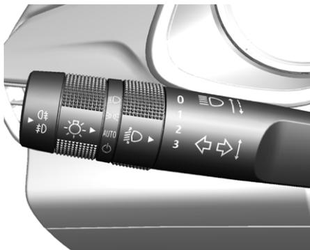
Переключатель освещения находится на рычаге переключения указателей поворота. Переключатель может быть установлен в одно из следующих положений:
