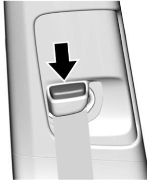
Нажав на кнопку разблокировки, переведите регулятор высоты в нужное положение. Чтобы переместить верхнюю точку крепления ремня вверх, достаточно сдвинуть вверх декоративную накладку. После того как регулятор перемещен в нужное положение, надавите на него вниз, не прилагая большого усилия, чтобы проверить его фиксацию на месте.
