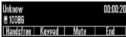
Во время вызова длительность разговора отображается на экране. Нажмите MEDIA PRESET (НАСТРОЙКА МЕДИА)  $\mathcal{L}$  для переключения между режимами громкой связи и телефона. Для завершения вызова нажмите SET (НАСТРОЙКА)  $\mathcal{L}$ . Чтобы открыть дисплей «Keypad» («Клавиатура»), нажмите  $\mathcal{L}$ . Нажмите  $\mathcal{L}$  для выключения или включения микрофона.
