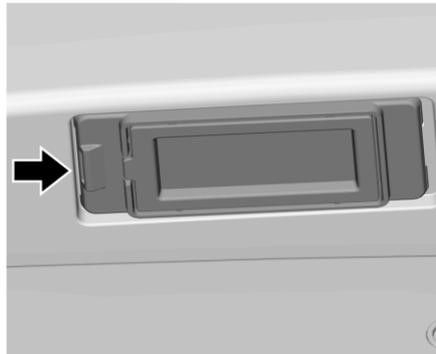
1. Подходящим инструментом вытащите патрон лампы, следя за тем, чтобы не натянуть провод.
