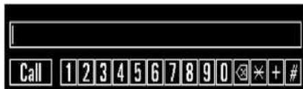
Используйте ручку  $\downarrow$  и кнопку SET (НАСТРОЙКА) для ввода вызываемого номера. Затем поверните ручку  $\downarrow$ , чтобы выбрать «Call» («Вызов»), и нажмите SET (НАСТРОЙКА), чтобы сделать исходящий вызов.
