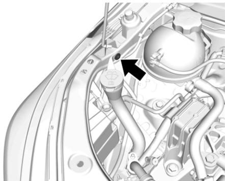
Для замены ламп на стороне пассажира необходимо предварительно снять заправочную горловину резервуара омывателя ветрового стекла.
