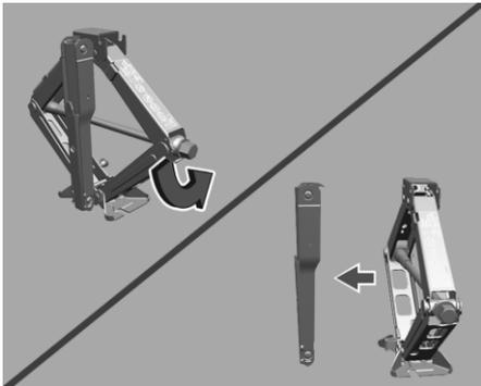
Чтобы снять гаечный ключ, необходимо опустить домкрат. Прежде чем укладывать поврежденное полноразмерное колесо в нишу для запасного колеса, выполните следующие действия:
