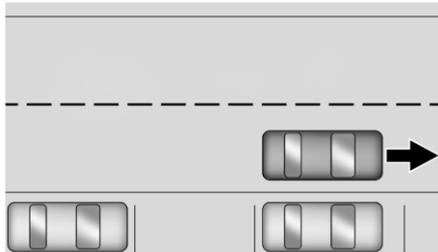
После полного прохождения места достаточного размера подается звуковой сигнал. На дисплее отображается символ остановки красного цвета и соответствующее сообщение.
