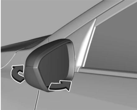
Для обеспечения безопасности пешеходов внешние зеркала складываются от удара определенной силы. Чтобы вернуть зеркало в рабочее положение, нужно слегка надавить на его корпус. Эта функция также полезна тем, что уменьшает полную ширину автомобиля, снижая вероятность повреждений при парковке. Прежде чем начинать движение, установите зеркала в рабочее положение.
