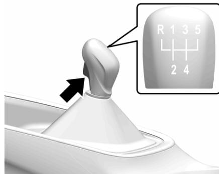
Положения рычага переключения передач:
