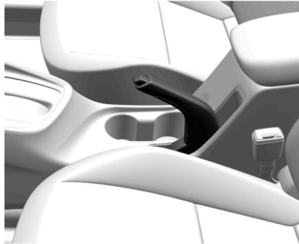
Не нажимая кнопку фиксатора, сильно затяните стояночный тормоз; на спуске или подъеме стояночный тормоз следует затягивать с максимальным усилием.
