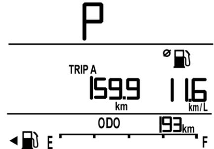
Счетчик текущего пробега показывает расстояние, пройденное автомобилем после последнего сброса показаний счетчика. На дисплее также отображается среднее значение расхода топлива. Для сброса показаний откройте соответствующую страницу и несколько секунд удерживайте нажатой кнопку SET/CLR.
