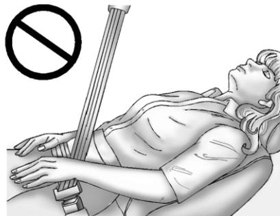
Нельзя наклонять спинку во время движения автомобиля.
