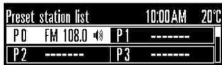
В списке запрограммированных станций выберите станцию, поворачивая ручку  $\curvearrowright$ . Нажмите и удерживайте кнопку SET (НАСТРОЙКА), чтобы сохранить текущую радиостанцию в списке избранного. После успешного сохранения станции подается звуковой сигнал.
