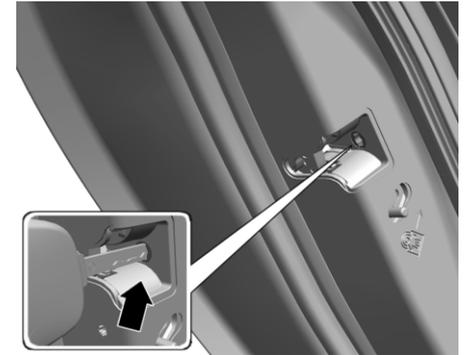
После этого дверь уже нельзя отпереть с помощью штифта, а только ручкой изнутри. Порядок блокировки или разблокировки замков дверей изнутри:
