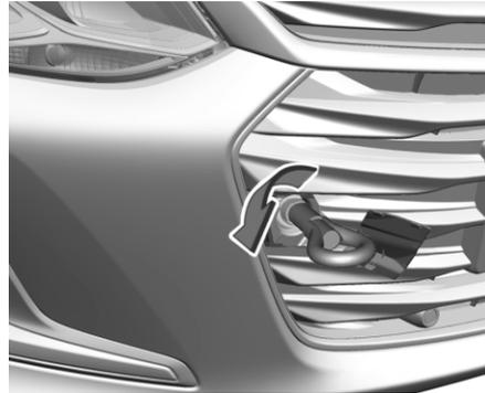
Заверните буксирную проушину до упора, остановив ее в горизонтальном положении. Буксирная проушина используется только для буксировки, а не для эвакуации автомобиля.
