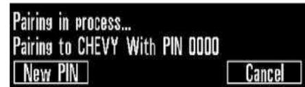
Включите Bluetooth на мобильном телефоне и найдите «CHEVY» для сопряжения с системой автомобиля. Выполняйте инструкции, всплывающие на экране.
