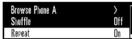
Поверните ручку  $\cup$  для выбора позиции «Repeat» («Повтор») и нажмите SET (НАСТРОЙКА), чтобы включить режим бесконечного воспроизведения, если он был выключен. Если имеющееся подключенное устройство BT не поддерживает эту функцию, на дисплей выводится сообщение «Repeat —————» («Повтор —————»).
