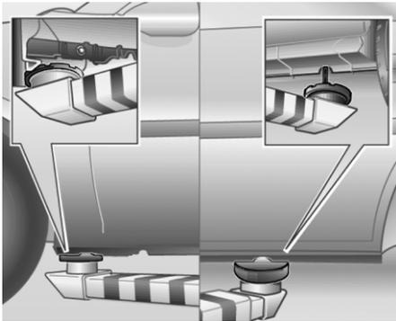
Опоры подъемника или домкраты должны устанавливаться в местах, показанных на иллюстрациях для передней и задней части автомобиля, между точками поддомкрачивания и колесными нишами.
