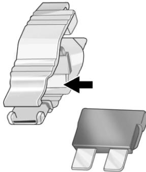
Съёмник устанавливают на предохранитель сверху или сбоку в зависимости от типа и вынимают предохранитель.
