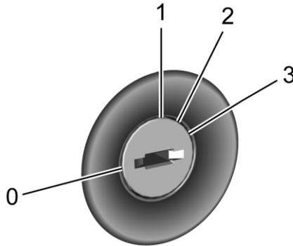
Ключ зажигания имеет четыре положения:
