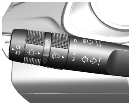
Для включения сигнала поворота полностью передвиньте рычаг вниз или вверх.
