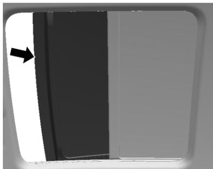
На уплотнителе и направляющих люка крыши может скапливаться пыль и грязь.
