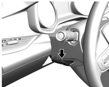
Чтобы выполнить регулировку рулевого колеса:
