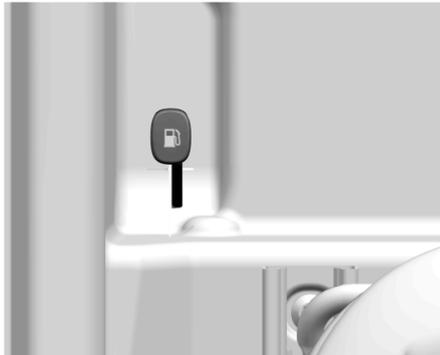
Потяните крышку люка на левом заднем крыле, чтобы открыть доступ к наливной горловине.
