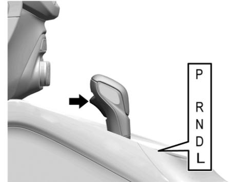
**P** : В этом положении блокируются ведущие колеса. Устанавливайте селектор в положение P (Парковка) при запуске двигателя, т.к. в этом случае автомобиль не сможет случайно тронуться.
