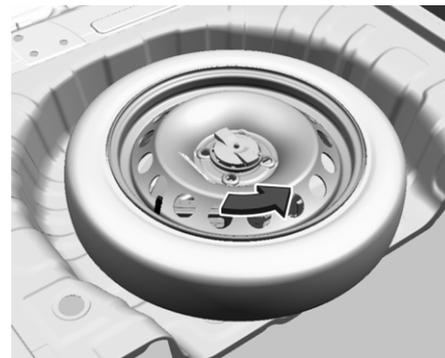
Отверните гайку-барашек запасного колеса против часовой стрелки и снимите запасное колесо.
