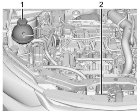
1. Расширительный бачок охлаждающей жидкости и крышка с предохранительным клапаном
