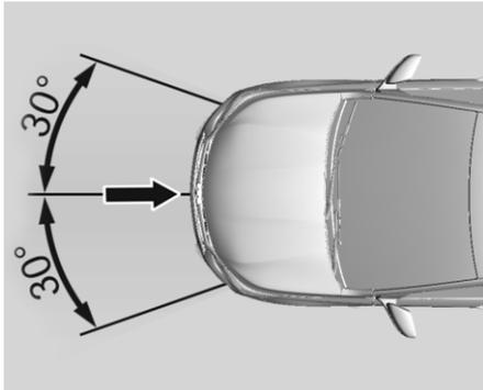
В случае удара определенной силы, происходящего на указанную область, происходит срабатывание передних подушек безопасности. Зажигание должно быть включено.
