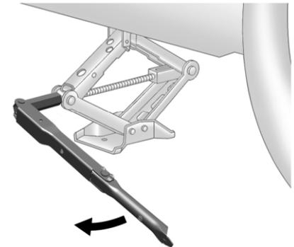
Поднимите автомобиль, вращая ручку домкрата по часовой стрелке. Поднимайте автомобиль, пока колесо не оторвется от земли.
