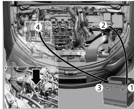
9. Подключите соединительные провода в следующем порядке:
