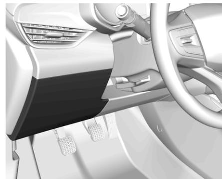
Установленный в панели приборов блок предохранителей расположен снизу со стороны водителя.
