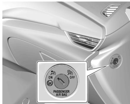
Система подушек безопасности переднего пассажира отключается с помощью выключателя, расположенного сбоку на панели приборов, доступ к которому обеспечивается при открывании двери переднего пассажира. Индикатор состояния подушки безопасности пассажира находится на потолочной консоли.
