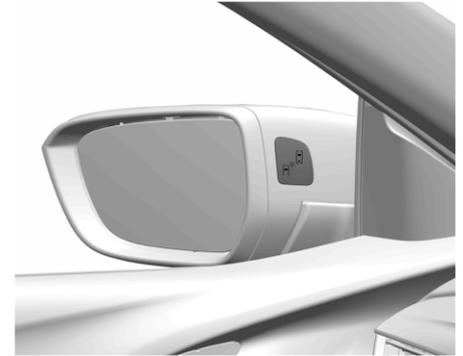
Система предупреждения о препятствиях в боковых мертвых зонах активируется, когда скорость автомобиля превышает 10 км/ч. Если скорость автомобиля превышает 140 км/ч, система выключается, и яркость свечения индикаторов в левом и правом наружных зеркалах заднего вида снижается; если затем скорость автомобиля уменьшится, индикаторы в зеркалах гаснут. Если после этого в мертвой зоне будет обнаружен автомобиль, индикатор в соответствующем зеркале заднего вида загорается.
