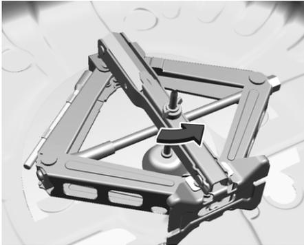
Отверните гайку-барашек против часовой стрелки.
