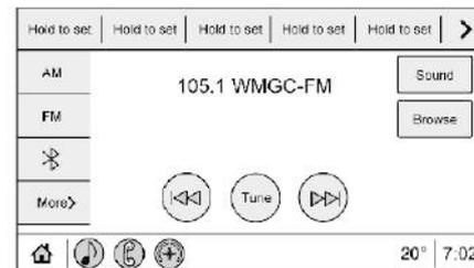
На экране диапазона AM или FM коснитесь значка  $\ll$  или  $\gg$  на дисплее информационно-развлекательной системы, чтобы выполнить поиск предыдущей или следующей станции или канала с устойчивым сигналом.
