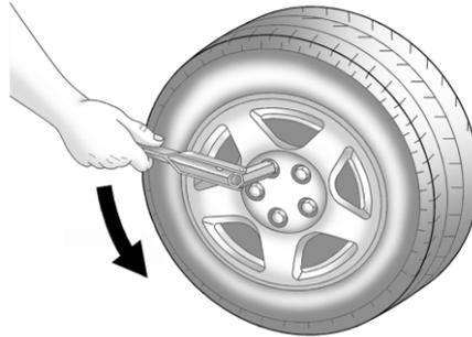
Установить колесный ключ так, чтобы он был надежно надет на гайку, слегка отвернуть каждую колесную гайку на пол-оборота.
