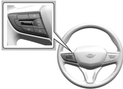
☺ : Нажатие на эту клавишу включает и выключает систему круиз-контроля. При включении круиз-контроля в комбинации приборов загорается белый индикатор.
