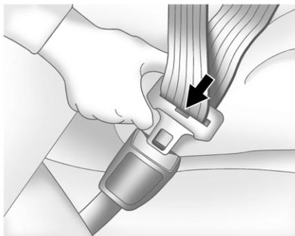
3. Введите язычок в замок, чтобы он зафиксировался со щелчком. Потяните язычок защёлки, чтобы проверить его крепление. Найдите на пряжке кнопку освобождения ремня, чтобы при необходимости его можно было быстро отстегнуть.
