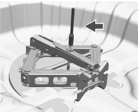
4. Прежде чем укладывать поврежденное полноразмерное колесо в нишу для запасного колеса, установите удлинительный болт.
