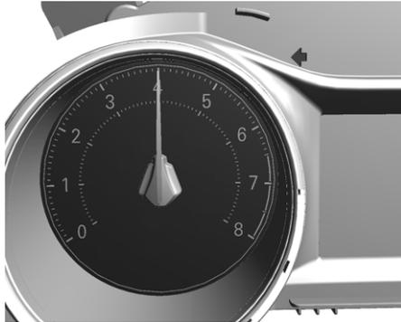
На тахометре отображается число оборотов двигателя в минуту (об/мин). Если двигатель работает, стрелка тахометра указывает количество оборотов коленчатого вала в минуту (об/мин). Показания тахометра могут изменяться в пределах нескольких сотен оборотов непосредственно в процессе остановки или повторного запуска двигателя.
