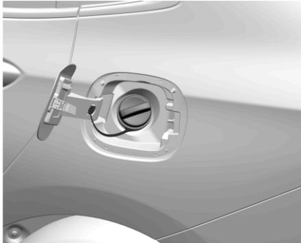
Пробка топливного бака находится под крышкой люка наливной горловины на левом заднем крыле.
