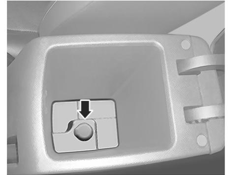
Розетки предназначены для электропитания такого вспомогательного электрооборудования, как мобильные телефоны, зарядные устройства GPS и любые другие электроприборы на 12 В, мощность которых не превышает 120 Вт. Автомобиль может быть оснащен розетками питания дополнительного оборудования:
