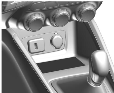
За подробной информацией о совместимости телефона или другого устройства обратитесь к дилеру. Зажигание должно быть включено в режим ACC / ACCESSORY (Питание вспомогательного оборудования) или в режим PAP (Питание дополнительного оборудования с задержкой отключения).
