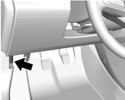
Потяните за ручку открывания капота. Ручка находится в салоне слева от рулевой колонки. Капот откроется и будет удерживаться на месте только предохранительным крючком.
