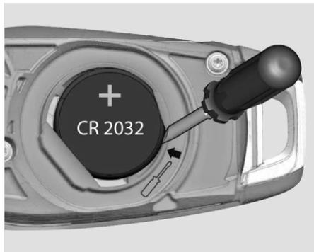
2. Извлеките элемент питания с помощью небольшой отвертки, поддев его в указанном на рисунке месте.
