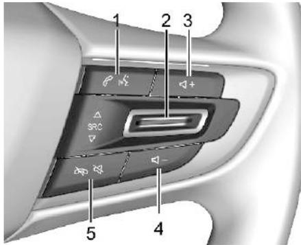
1 = : В автомобилях с Bluetooth нажмите для взаимодействия с этими системами или приема входящего вызова.
