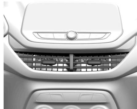
Отрегулируйте положение заслонок сопел вентиляции ползунком, чтобы изменить направление воздушных потоков.
