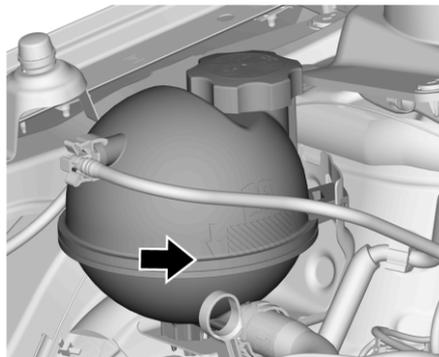
Расширительный бачок охлаждающей жидкости находится в моторном отсеке автомобиля, на стороне пассажира. См. Общий вид моторного отсека (Двигатель 1,2 л с турбонаддувом) ⇨ 9-6 или Общий вид моторного отсека (Двигатель объемом 1,2 л) ⇨ 9-7.
