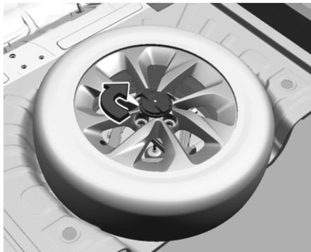
5. Уложите поврежденное полноразмерное колесо в нишу для запасного колеса и затяните гайку-барашек.
