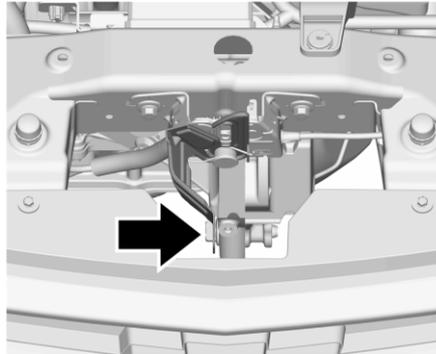
Сдвиньте лапку предохранительного крючка вправо и откройте капот.
