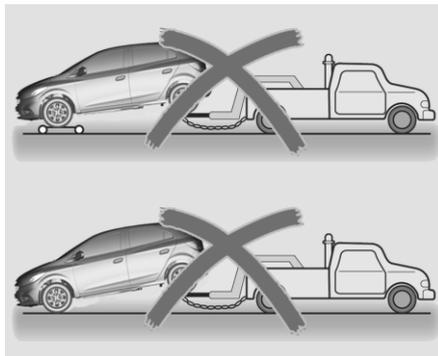
Буксировка данного автомобиля с двумя колесами на дороге не допускается.
