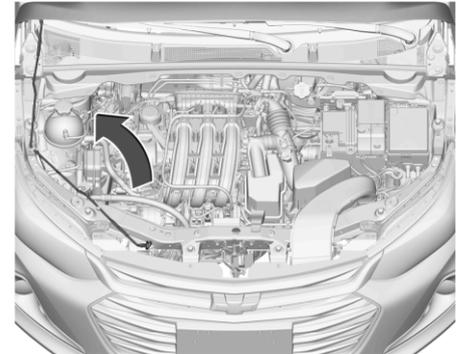
Чтобы капот не закрылся, вставьте подпорку в отверстие капота.
