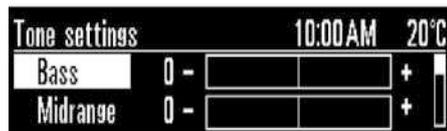
1. Bass (Низкие частоты): Поверните ручку ↻ для настройки значения низких частот.
