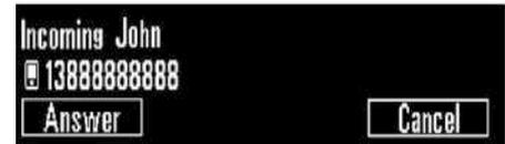
При входящем вызове на экране радиоприемника отображается номер телефона или контакты входящего вызова. Нажмите MEDIA PRESET (НАСТРОЙКА МЕДИА)  $\mathcal{L}$ , чтобы ответить на вызов, или нажмите SET (НАСТРОЙКА)  $\mathcal{L}$ , чтобы отклонить вызов.
