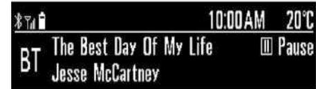
Нажмите MEDIA PRESET (НАСТРОЙКА МЕДИА) в блоке органов управления на консоли, чтобы включить режим аудиисточника «BT», если устройство Bluetooth успешно сопряжено.
