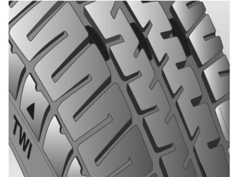
Кроме того, подлежат замене шины с протектором, изношенным до индикаторов допустимого износа. На иллюстрации показано, где можно определить глубину протектора.
