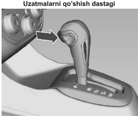
**P :** Avtomobilarni to'xtatib qo'yish holati, g'ildiraklar quflanadi, bu uzatma holatiga faqat avtomobil to'xtab turganda va qo'l tormizi tortib qo'yilganda o'tkazish mumkin.
